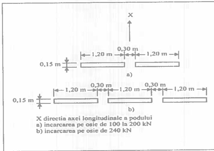
Fig. 5. Distribuția și dimensiunile suprafețelor de contact ale roțiilor unei osii la vehiculele speciale
