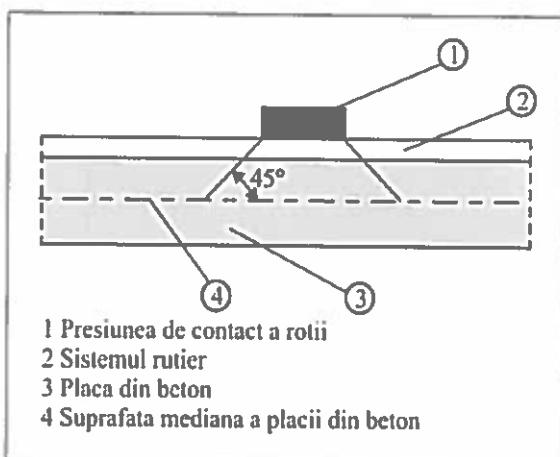
Fig. 6 - Repartiția încărcărilor concentrate prin sistemul rutier și o placă din beton
