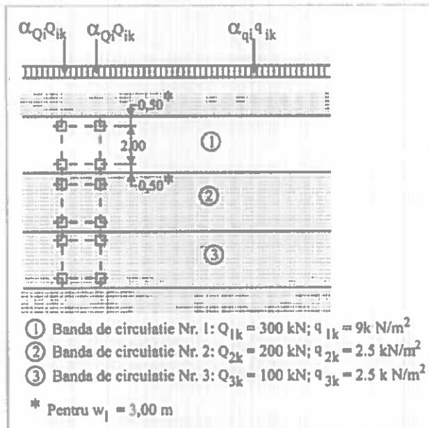
Fig. 2. Aplicarea modelului de încărcare 1 - verificări generale
